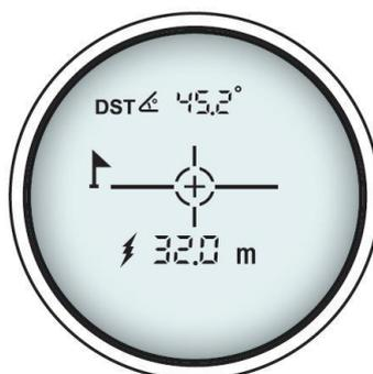
Режим захвата флагштока предназначен для измерения сигнальных мачт, опорных линий электропередач и других вытянутых объектов.
