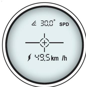
Непрерывное нажатие кнопки позволяет измерять скорость подвижных объектов, прибор фиксирует скорость с периодичностью 1 сек.
